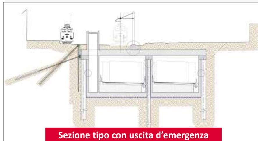
Sezione tipo con uscita d'emergenza
