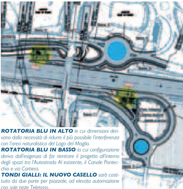
**ROTATORIA BLU IN ALTO** le cui dimensioni derivano dalla necessità di ridurre il più possibile l'interferenza con l'area naturalistica del Lago del Maglio.
